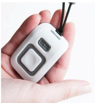
Ce couplage accéléromètre/baromètre augmente considérablement le niveau de performance en évitant les « faux positifs et négatifs » constatés.
