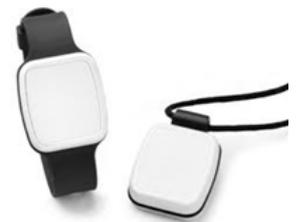
En utilisant un algorithme innovant et un nouveau capteur de pression, il est conçu pour détecter automatiquement une chute lourde.
