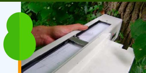
Le Resistograph® permet d'évaluer l'état du cœur de bois. Une fine aiguille pénètre dans l'arbre et enregistre la résistance qu'elle rencontre. Couplée à un traceur, elle définit une courbe de mesure sur laquelle on peut observer les différences entre le bois intact et le bois endommagé.
