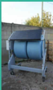
À la Maison de la Nature, un composteur solaire 100% recyclable vient compléter les différents modes de compostage déjà pratiqués. D'une capacité de 1000 litres, il peut transformer jusqu'à 500 kg de biodéchets par mois en toute autonomie grâce à son système d'alimentation solaire. Le compost obtenu sera utilisé pour nourrir la trame brune et des végétaux. Une pratique vertueuse qui participe à la préservation de l'écosystème.
